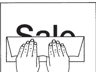
Ziehen Sie das Application Tape in einem Winkel von fast 180° ab. Kontrollieren Sie die Ränder der einzelnen Folienstücke und drücken Sie sie bei Bedarf noch einmal mit dem Raket an.
