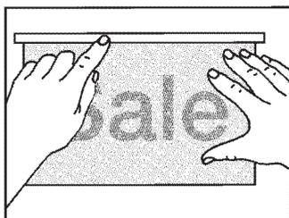
Befestigen Sie die Folie (einschließlich Abdeckpapier und Application Tape) mit Stücken von Kreppklebeband in der gewünschten Position und bringen Sie horizontal oder vertikal ein "Scharnier" aus Kreppklebeband an.
