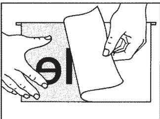
Klappen Sie die Folie um dieses "Scharnier" herum auf den Rücken und ziehen Sie ein Stück Abdeckpapier ab (bei kleineren Formaten evtl. das gesamte Abdeckpapier). Achten Sie darauf, dass die Folie nicht schon vor dem Andrücken am Untergrund klebt.
