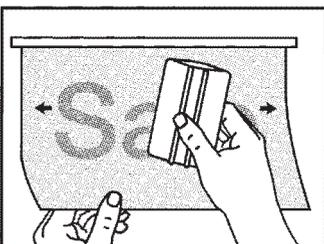
Drücken Sie die Folie mit einem Raket an, ohne die haftende Seite zu berühren. Streichen Sie dabei allmählich von der Mitte des "Scharniers" aus nach außen, bis die ganze Folie verklebt ist.
